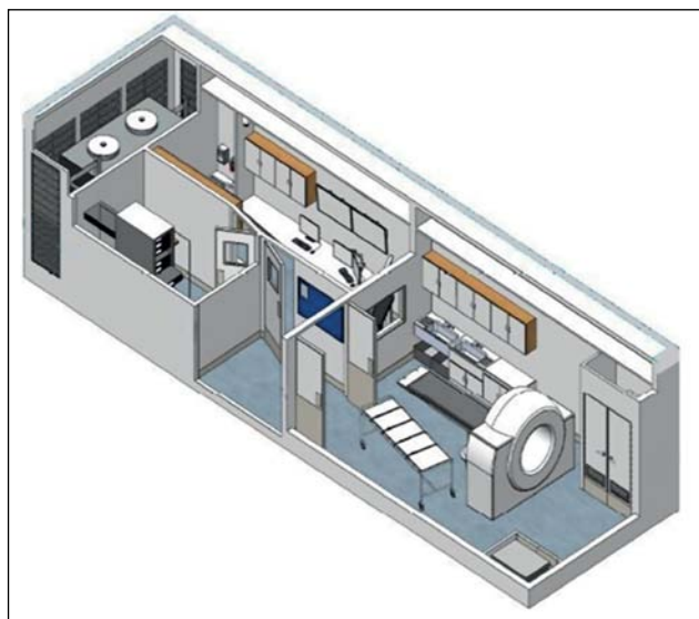
Рис. 1. Схема передвижного комплекса для проведения виртопсии.
