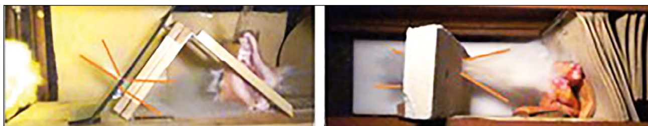
Рис. 2. Покадровое воспроизведение прохождения огнестрельного снаряда через преграду и биологическую мишень: a — триплекс; b — комбинированная преграда из керамогранита и пенобетона.
