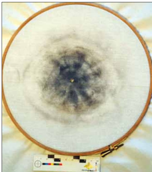
Рис. 2. Лицевая поверхность мишени с термически изменёнными нитями (расстояние выстрела 5 см).
