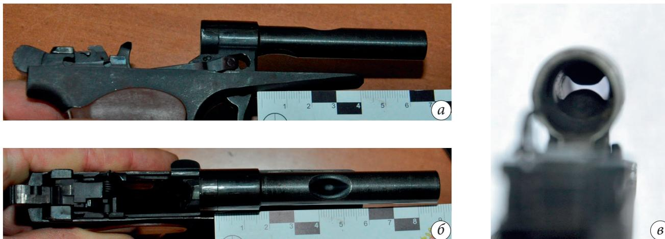
Рис. 2. Пистолет МР-80-13Т: конструкционные изменения ствола, препятствующие стрельбе неэластичными снарядами: а – вид сбоку, б – вид сверху, в – канал ствола
