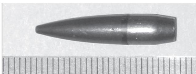
Рис. 2. Общий вид пули патрона АК-74 5,45 мм
