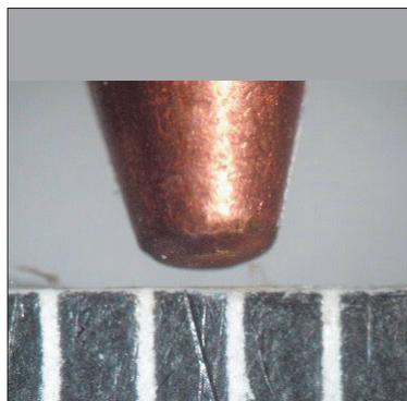
Рис. 3. Вершинка головной части пули патрона АК-74 5,45 мм
