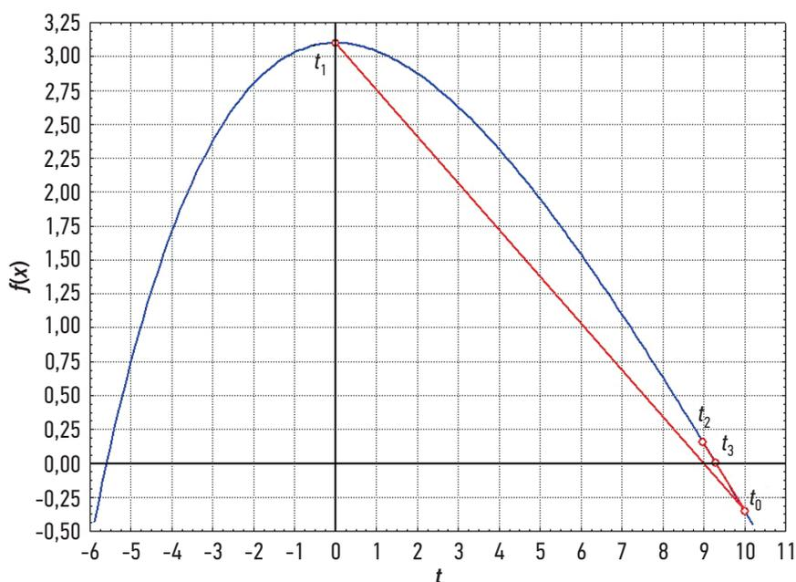
Рис. 2. Геометрия решения уравнения (9) методом хорд для данных примера 1. Показаны первые 3 итерации при  $t_0=10$  и  $t_1=0,1$  ч.
