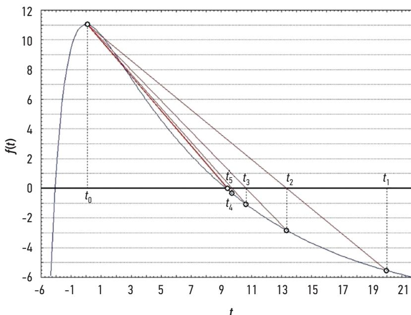
**Рис. 3.** Геометрия решения уравнения (10) методом хорд для данных примера 2. Показаны первые 5 итераций при  $t_0=0,1$  и  $t_1=20$  ч.
