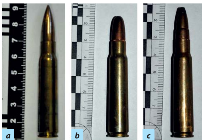
Рис. 2. Патроны 8×57 JS, применявшиеся в эксперименте: а — с пулей оболочечной однорадиусной оживальной формы; б — пулей оболочечной со сферически скруглённой головной частью; с — пулей полуоболочечной с головной частью в форме усечённого конуса.
