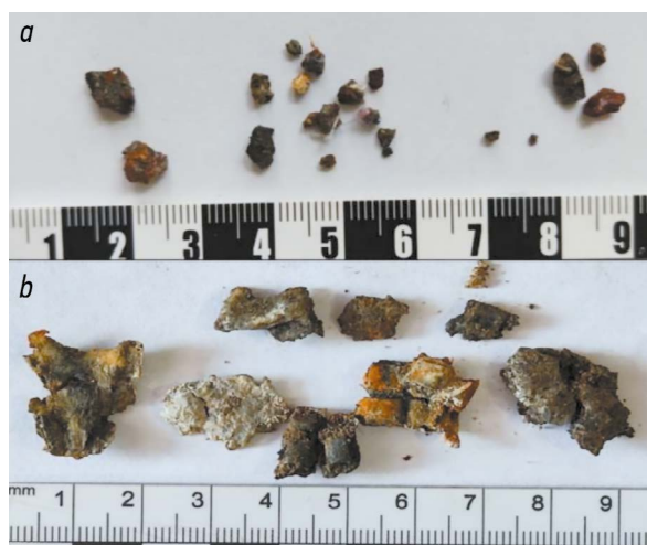
Рис. 2. Вид осколков гранат Ф-1 и РГО: a — осколки, извлечённые из биологического имитатора тела человека после взрыва гранаты Ф-1 на расстоянии 20 см от мишени; b — осколки, извлечённые из биологической мишени после контактного взрыва гранаты РГО. Fig. 2. View of fragments from F-1 and RGO grenades: a — fragments extracted from a biological simulator of the human body after the explosion of F-1 grenade at a distance of 20 cm from the target; b — fragments extracted from a biological target after the contact explosion of RGO grenade.
