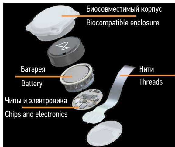
Рис. 1. Имплантат, используемый в системе N.
